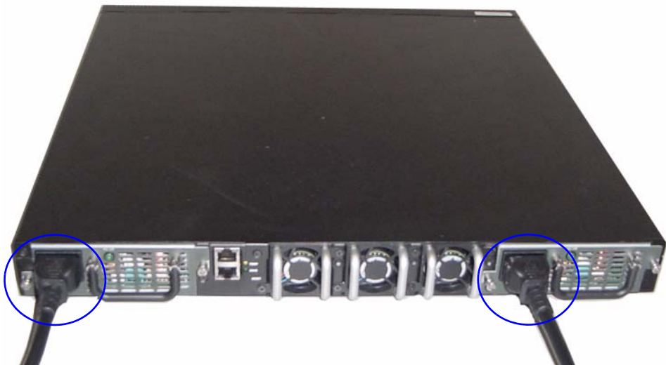
図 2 電源ケーブルの接続
